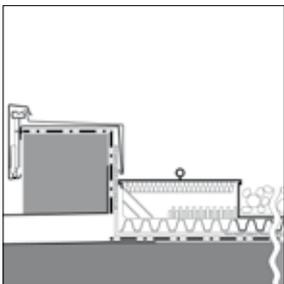
El desagüe de cubiertas planas puede efectuarse también a través de sumideros junto a petos perimetrales o por gárgolas montadas en los petos. Gracias a la caja de control junto al peto se asegura que las instalaciones de desagüe sean de fácil acceso y limpieza.
