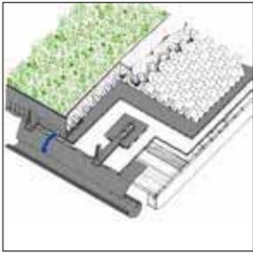
En las cubiertas inclinadas las aguas pluviales se evacuan principalmente por canalones. Las fuerzas de empuje se deben distribuir uniformemente en la cubierta con la ayuda del perfil TRP 140 o en combinación con petos perimetrales.
