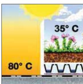
Bajo una cubierta vegetal la impermeabilización prolonga su vida útil al estar protegida de temperaturas extremas, radiaciones ultravioletas y tensiones mecánicas, reduciendo los costes de renovación.
