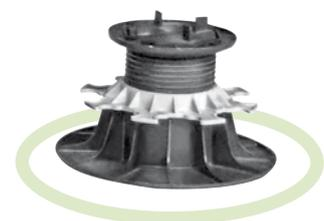
Soporte para losas regulable en altura de modo continuo, de polipropileno, para la colocación de pavimentos sobre superficies con y sin inclinación. Gracias a los divisores de juntas integrados, con un grosor de 3 mm, se consigue una imagen lineal de las juntas y excelente función de drenaje.
