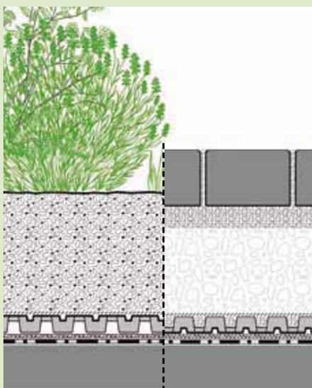
Pavimento (adoquinado, min. de 10 cm)
