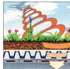
Las cubiertas vegetales aíslan acústicamente hasta 3 dB y son capaces de mejorar la insonorización hasta 8 dB, siendo una protección eficaz para edificios situados en entornos con alta contaminación acústica.
