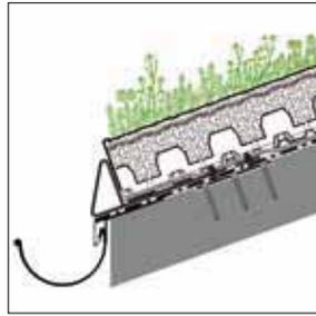
Las cubiertas verdes inclinadas se diseñan hasta el borde. Utilizando el soporte antiempuje LF 300 con el perfil de alero TRP, las barreras de retención impermeabilizadas pueden ser reemplazadas.
