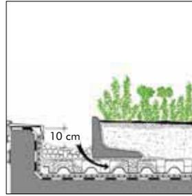
Incluso las cubiertas verdes intensivas con alturas más altas de sistema se pueden instalar en las cubiertas con petos perimetrales bajos. Elementos angulares en hormigón o perfiles en acero inoxidable se utilizan para bordear la plantación permitiendo un espesor más alto del sustrato.
