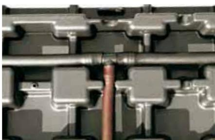
Los tubos se insertan en las guías y se conectan al dispositivo de control.
