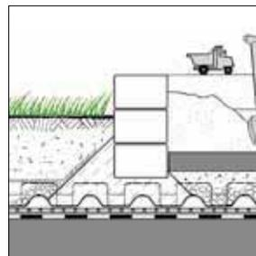
Las limitaciones entre zonas accesibles y zonas de juego puede realizarse mediante troncos de madera impregnados, ladrillos, piedras o baldosas. Para una mayor seguridad de la impermeabilización de la cubierta se recomienda colocar en zonas de juego infantiles una protección adicional en forma de baldosas que eviten que los niños accedan al fondo del sistema.
