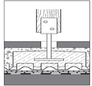
El elemento Floradrain® FD 60 se puede utilizar como encofrado perdido si se requieren fundamentos sin que sea necesario perforar la impermeabilización. El sistema acanalado de la placa de drenaje asegura el movimiento libre de las aguas sobrantes.
