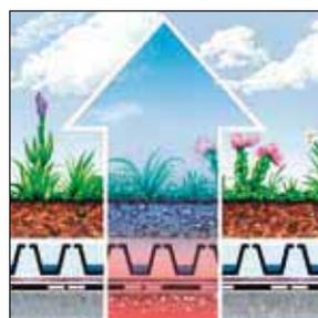
Las cubiertas vegetales con placa drenante termoaislante (como Floratherm®) consiguen un aislamiento térmico significativo reduciendo el consumo energético del edificio.
