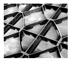
Elemento en forma de retícula fabricado de polietileno reciclado, utilizable para sujetar la capa vegetal en cubiertas con pendiente, sujeción de tierra en taludes, encofrado en solados etc.
