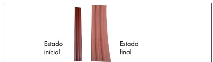
Comportamiento de la junta hidroexpansiva al contacto con agua. Estado inicial y estado final a 160 horas de contacto con el agua.
