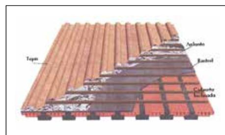
Fig. 4: Cubierta con cámara doble
