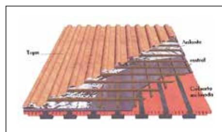
Fig. 3: Cubierta con cámara simple
