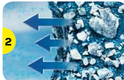
Cuando la humedad ambiental disminuye, la humedad presente en la red de micro-capilares 3D se libera inmediatamente a la atmósfera. La fachada seca mucho más rápido, evitando de esta manera la rápida proliferación de microorganismos.
