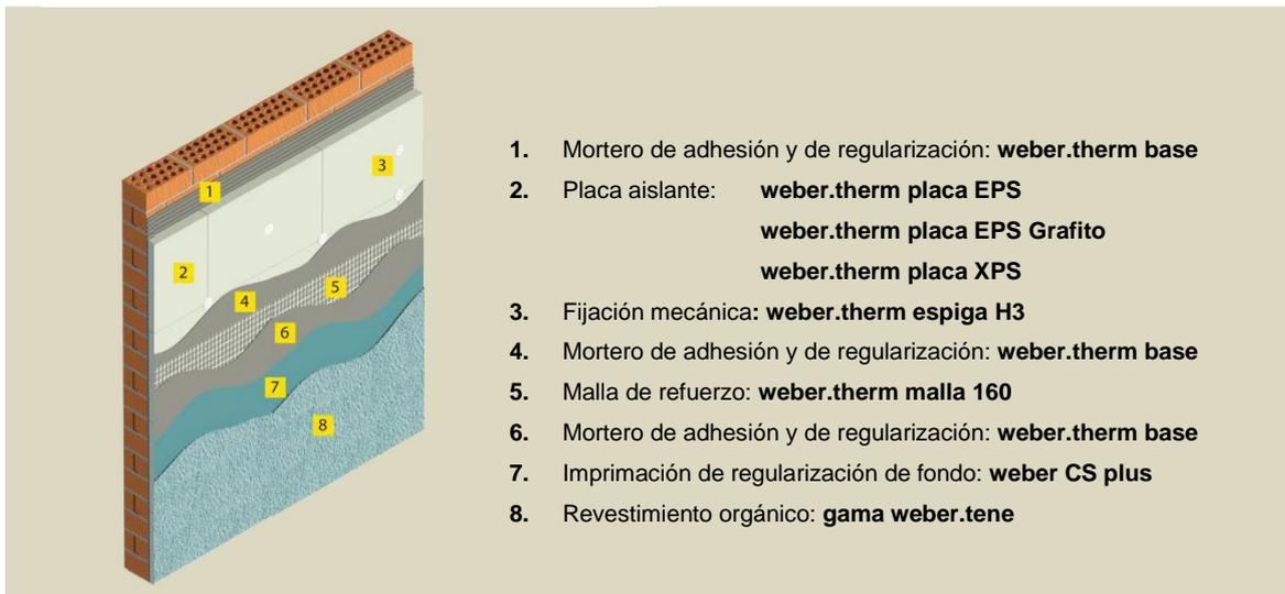
**Observación:** posibilidad de utilizar **weber.therm placa EPS grafito** para dotar al sistema de una capacidad aislante mayor. O bien la posibilidad de utilizar **weber.therm placa XPS** para dotar al sistema de una capacidad mecánica mayor al aislamiento.
