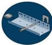
Colocar horizontalmente en la parte inferior del sistema y fijarlo cada 30 – 50 cm con un tornillo.
