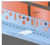
En las juntas entre perfiles dejar 2 – 3 mm para absorber la dilatación de éstos.
