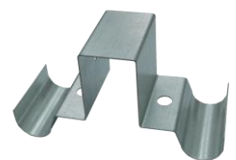
E) Pletinas de acero conformado con tratamiento Geomet 500B para la sujeción de la perfilería de cumbrera de dimensiones 250x30 mm
