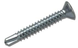
C) Tornillo autotaladrante con tratamiento Geomet 500B de dimensiones 4,8x38 mm para la fijación de las tejas de cumbrera
