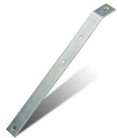
E) Pletinas de acero conformado con tratamiento Geomet 500B para la sujeción de la perfilería de cumbrera de dimensiones 250x30 mm
