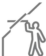
Las ventanas de tejado giratorias accionamiento manual superior permiten colocar muebles justo debajo de ellas sin obstruir su funcionamiento. Recomendamos una altura de instalación que permita una línea de visión clara hacia el exterior tanto de pie como sentado. Ten en cuenta que la altura ideal de la ventana depende de la pendiente del tejado.
