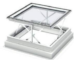
La ventana de cubierta plana eléctrica para extracción de humos y calor VELUX CSP se abre automáticamente en caso de incendio y cumple con todos los requisitos legislativos pertinentes de la UE. La ventana se puede abrir para que entre aire fresco cuando se necesita ventilación. Una fabricación antirrobo proporciona seguridad adicional y un vidrio interior laminado evita que el cristal se astille en caso de rotura.
