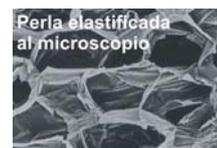
El efecto "muelle" de la elastificación favorece el comportamiento masa + muelle + masa, aportando así poder de aislamiento acústico.
