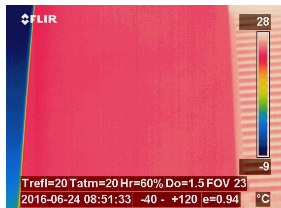
Fig. 14: Ausencia de puentes térmicos en fachada frontal del edificio 1.
