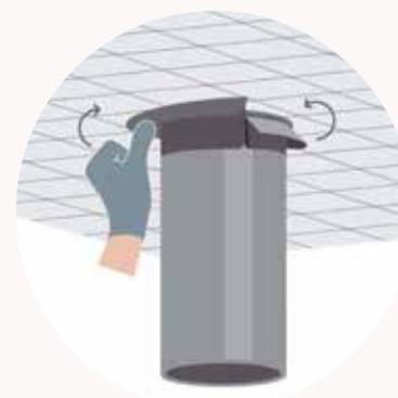
4. **Después de haber retirado la segunda protección desechable**, pegar la brida PassFlex a la membrana de manera simétrica y circular aprovechando la elasticidad óptima del PassFlex.
