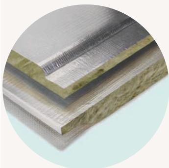
Panel de lana mineral URSA AIR para la construcción de conductos de climatización conforme a la norma UNE EN 14303, recubierto en su cara exterior por un complejo tejido de aluminio de apariencia apta para conductos vistos y con aluminio puro reforzado en su cara interior. Reacción al fuego (Euroclases) A2, totalmente incombustible.
