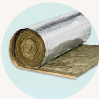
Manta de lana mineral URSA AIR para el aislamiento exterior de conductos metálicos de climatización conforme a la norma UNE EN 14303, recubierta por su cara exterior con un complejo kraft-aluminio reforzado y provisto de lengüeta.
