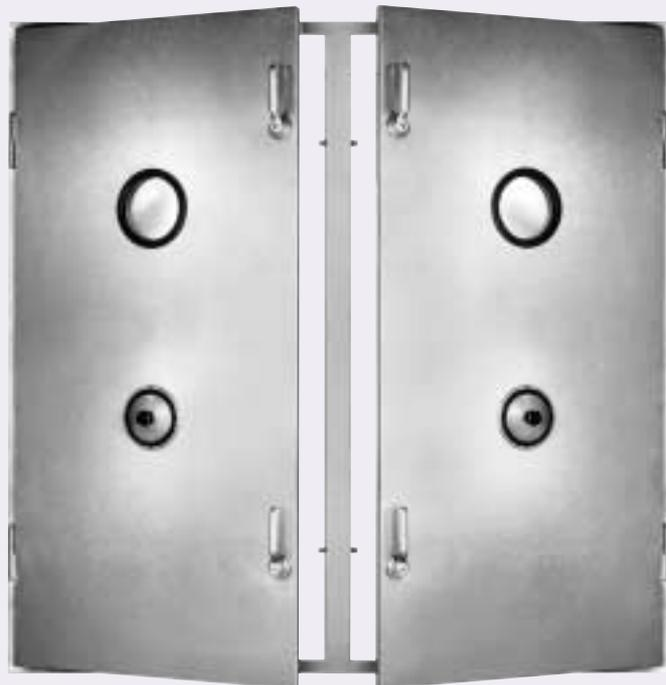
Las puertas de acero estancas al aire se utilizan en instalaciones de ventilación, salas de máquinas y almacenes, cámaras de filtración, climatizadores y similares. Cuando las puertas de acero están a la intemperie, éstas han de protegerse – dado el caso – con un pintado contra la corrosión. Su ejecución robusta garantiza por sí misma una fuga de aire reducida con presiones elevadas. En las ejecuciones con aislamiento acústico (ejecuciones X) se consigue además un buen aislamiento acústico.
