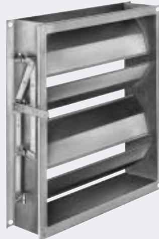
Las compuertas de regulación se utilizan preferentemente para el control del caudal y de la presión en instalaciones de climatización y ventilación. **Adicionalmente, en el caso de las Series JZ-L y JZD-G, se cumple con las exigencias de estanqueidad de DIN 1946 (fugas <math>< 10 \text{ m}^3/\text{h} \cdot \text{m}^2</math> de sección de compuerta para una diferencia de presión de 100 Pa).**
