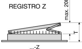
Las partes posteriores o accesorios se unen en fábrica a su rejilla correspondiente. Existen diferentes tipos de accesorios, son de chapa de acero y con superficie pintada al polvo en color negro (RAL 9005).
