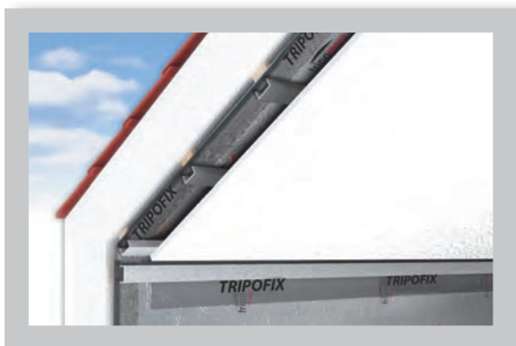
Acabado de placa de yeso laminado.
