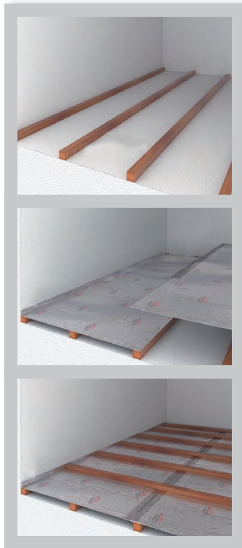
Rastrelado en desván. Colocación del aislante. Desván transitable.
