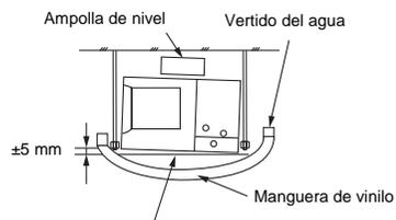
Instale los puertos de ambos lados, de toma de aire y de suministro de aire, dentro de  $\pm 5$  mm.
