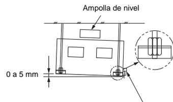
Instale la unidad principal dentro de 5 mm mientras baje ligeramente el lado del puerto de conexión del tubo de drenaje.
