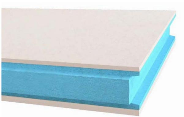
**THERMOCHIP FLOOR** es la solución para **forjados interiores entre plantas** y **forjados sanitarios**. Se instala sobre la estructura portante del forjado y una banda de caucho. Sobre él se puede disponer un tablero de alta densidad y un panel técnico de suelo radiante, configurable según la demanda energética de cada proyecto. El panel se recubre con un tablero de fibro-yeso que servirá de soporte al revestimiento final de la estancia.
