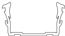
T411006 Junta de acristalamiento de 26 mm Marca de color: Azul
