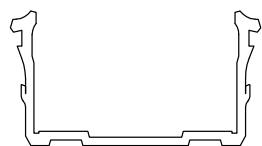
T411007 Junta de acristalamiento de 28 mm Marca de color: Verde
