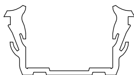
T411005 Junta de acristalamiento de 24 mm Marca de color: Rojo
