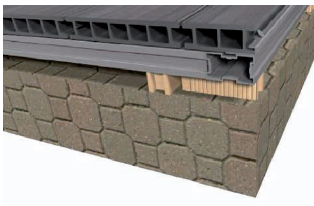
51. Detalle perfil de inicio atornillado al rastrel.
