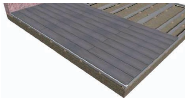
17. Ejemplo de disposición de lamas según rastrelado.
