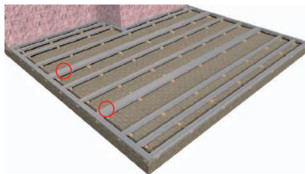
16. Estructura de rastreles para encuentro entre testas intermedio.
