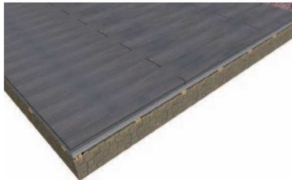
50. Final de la instalación con lamas cortadas longitudinalmente y colocadas.
