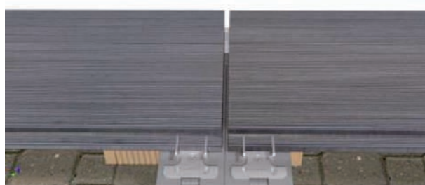
19. Doble rastrelado entre testas con un clip para cada lama.
