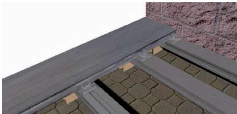
21. Detalle lama instalada en rastreles de extremo de instalación.
