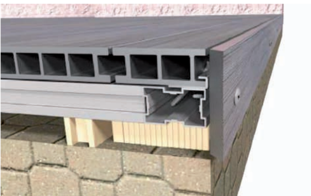
60. Detalle de la tapeta atornillada al centro del rastrel.
