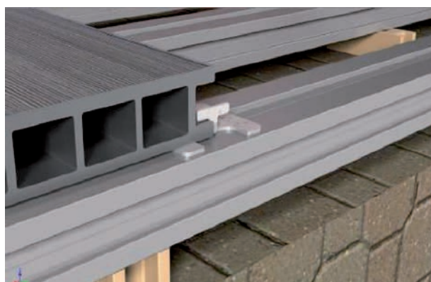
42 Clip y tornillo de acero inoxidable sobre rastrel de aluminio. Testa de tarima apoyada sobre el rastrel.
