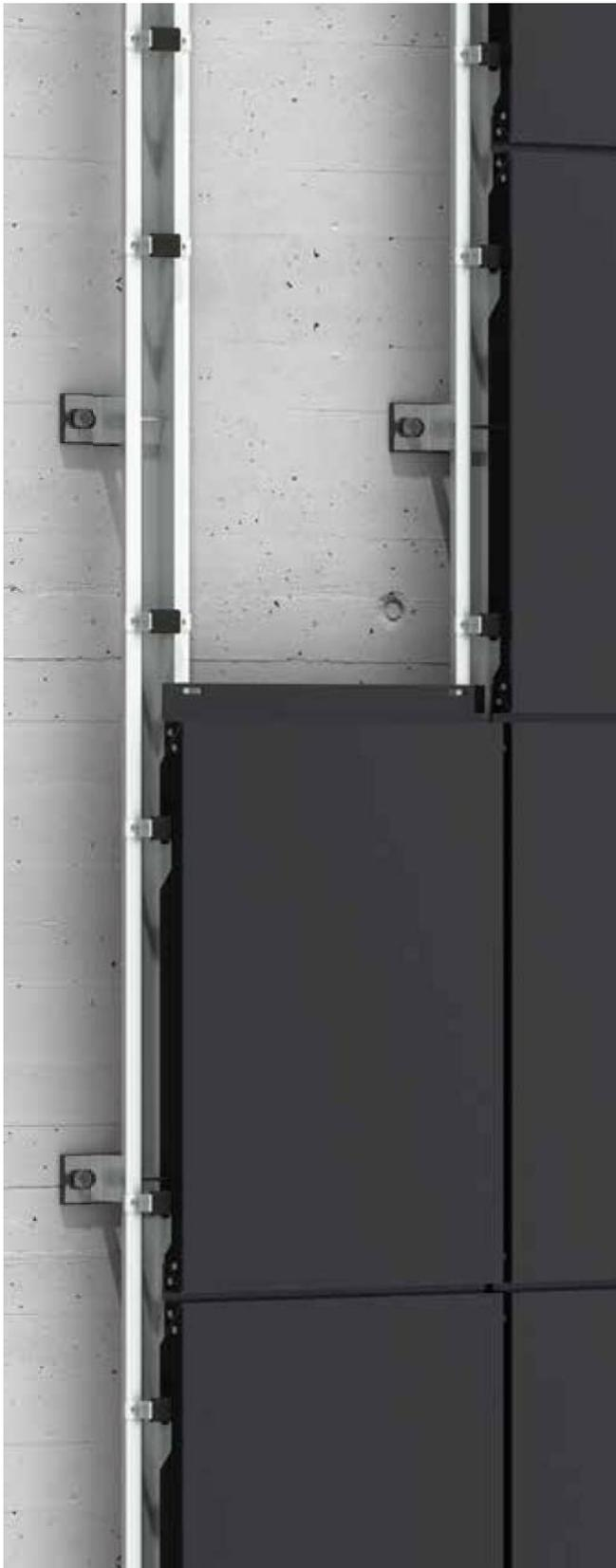
El **STB-CH** es un sistema kit a base de bandejas colgadas procedentes de **panel composite STACBOND STRUGAL para montaje de fachadas ventiladas**. Es un sistema de fijación oculta, versátil y de rápido montaje, en el cual las modulaciones de las bandejas pueden ser tanto horizontales como verticales. El sistema STB-CH cumple con todos los requisitos para poder ejecutar los recubrimientos arquitectónicos más vanguardistas.
