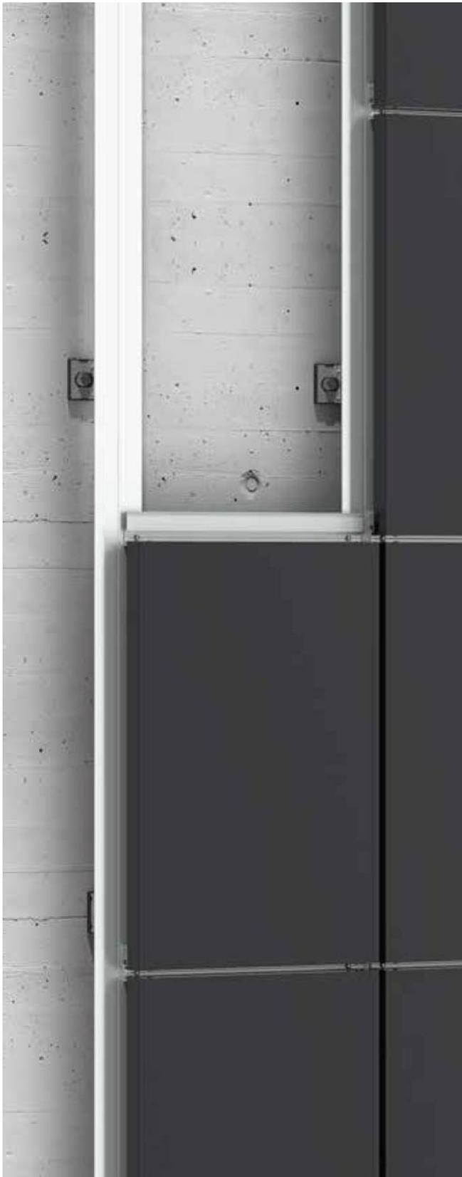
El **STB-T-SZ** es un sistema kit a base de bandejas procedentes de **panel composite STACBOND STRUGAL para montaje de fachadas ventiladas**. Es un sistema machihembra de fijación oculta, versátil y de rápido montaje diseñado especialmente para desarrollar fachadas con modulación horizontal con predominio de partes ciegas y/o poca superficie de huecos o huecos lineales.
