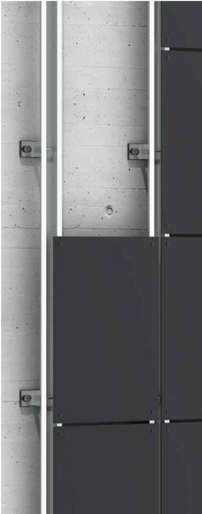
El **STB-REM** es un sistema kit de paneles sin conformar procedentes de **panel composite STACBOND STRUGAL para montaje de fachadas ventiladas**. Se trata de un sistema de fijación vista y rápido montaje, que admite tanto despieces horizontales como verticales. Es un sistema muy versátil que se adapta perfectamente a cualquier tipología arquitectónica y ofrece la posibilidad de ejecutar de forma sencilla zonas curvas.
