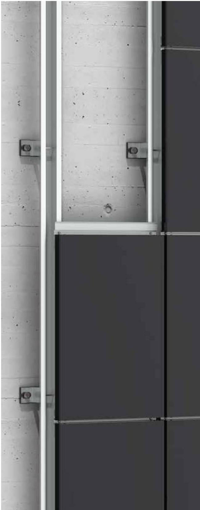
El **STB-SZ** es un sistema kit a base de bandejas procedentes de **panel composite STACBOND STRUGAL para montaje de fachadas ventiladas**. Es un sistema machihembrado de fijación oculta, versátil y de rápido montaje diseñado especialmente para desarrollar fachadas con modulación horizontal con predominio de partes ciegas y/o poca superficie de huecos o huecos lineales.
