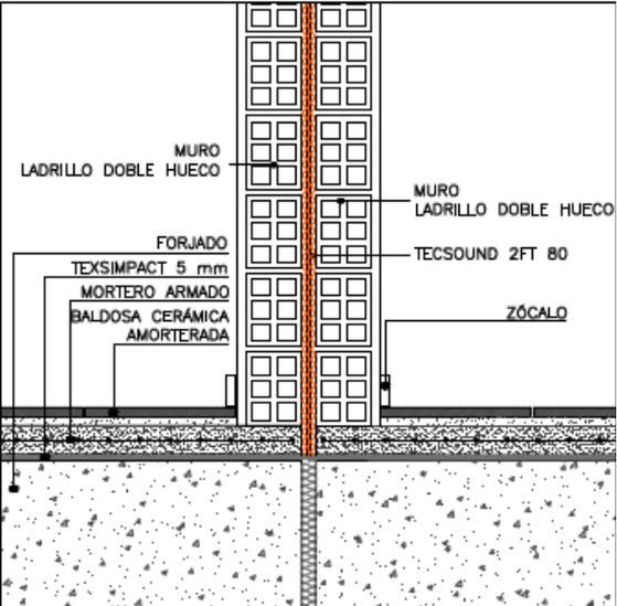
Datos según ensayo de aislamiento acústico al ruido aéreo según UNE-EN ISO 140-3:1995 por laboratorio homologado Applus e Instituto de Acústica.
