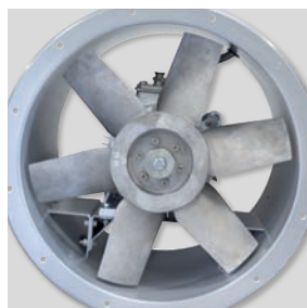
Hélice de aluminio de una sola pieza, equilibrada dinámicamente según norma ISO 1940 para reducir ruido y evitar vibraciones.
