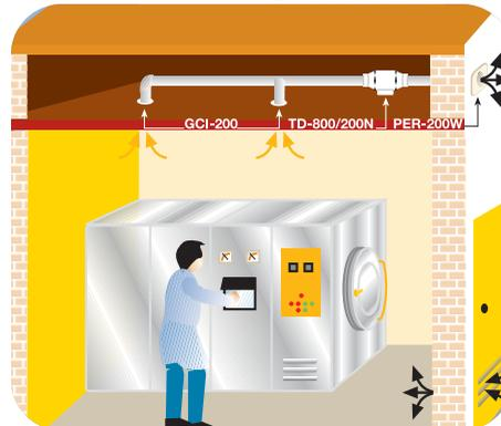
Problema: Eliminar el calor en una sala generado por un autoclave.
