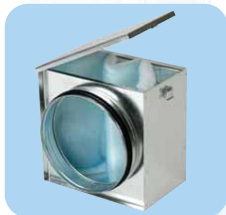
Las cajas filtrantes MFL disponen de tapa de apertura fácil, para proceder a un rápido cambio del elemento filtrante
