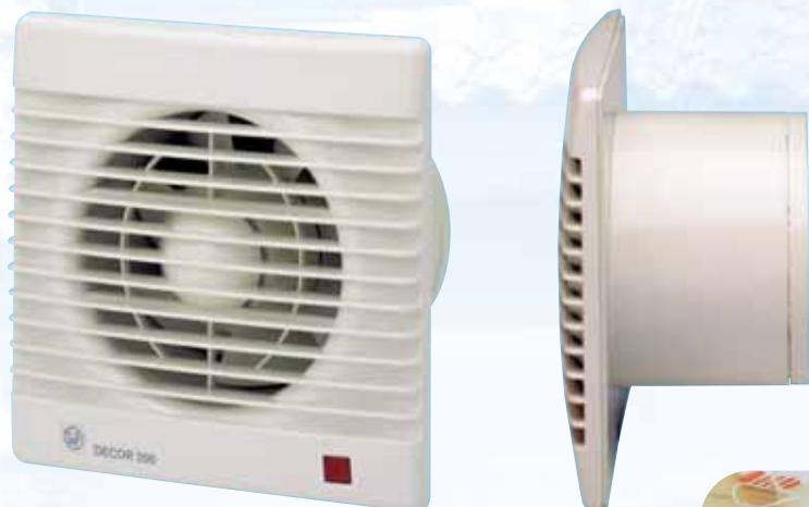
Ventiladores helicoidales **extraplanos**, con caudal aproximado de 200 m<sup>3</sup>/h, compuerta antirretorno incorporada, luz piloto de funcionamiento, motor 230V-50Hz, IP44, Clase II, con protector térmico incorporado.
