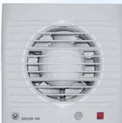
Están provistos de un detector de presencia. El aparato se pone en funcionamiento de manera automática cuando detecta movimiento hasta una distancia máxima de 4 metros. Dispone también de temporizador regulable entre 1 y 30 minutos, período durante el cual el aparato seguirá funcionando tras la detección del movimiento.
