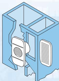
EDM 80L: Instalación sustituyendo las rejillas de ventilación existentes
