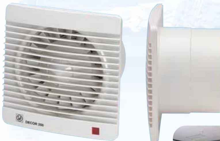
Ventiladores helicoidales **extraplano**, con caudal aproximado de 300 m<sup>3</sup>/h, compuerta antirretorno incorporada, luz piloto de funcionamiento, motor 230V-50Hz, IP44. Clase II, con protector térmico incorporado.
