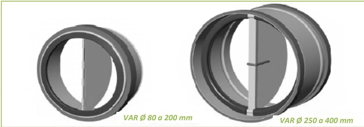
Las compuertas anti-retorno VAR están realizadas en acero galvanizado embutido para los diámetros 80 a 200 mm, y soldado y molteado para los diámetros 250 a 400 mm. Están destinadas para equipar instalaciones de ventilación con funcionamiento puntual, permitiendo evitar la entrada de aire en los locales cuando el ventilador está parado.
