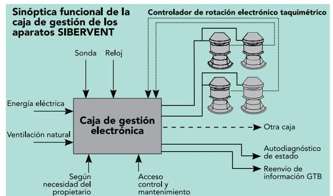
Dentro de nuestro sistema de ventilación híbrida, la caja de gestión controla los aparatos SIBERVENT según las condiciones climáticas y de programación, que permiten la modularidad de los caudales. A demanda del propietario, los intervalos de programación pueden adaptarse a sus necesidades.
