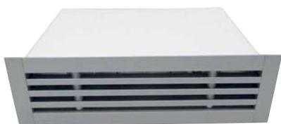
La rejilla **RIL-DUP** tiene una profundidad de sólo 13mm lo que permite colocarla en tabiques de placas de yeso laminado sin tener que cortar los tabiques que le sujetan.
