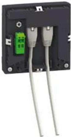
Conexión con la pantalla de visualización FDM121.
