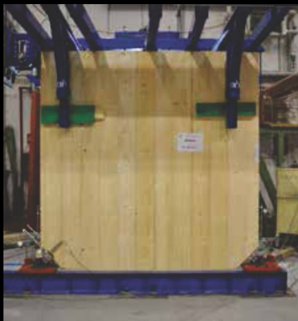
Ensaio experimental de parede com X-RAD e ligação ao chão
