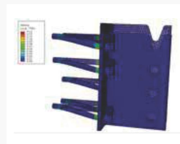
Confrontação do estado inicial (não deformado) com a configuração final do ensaio
