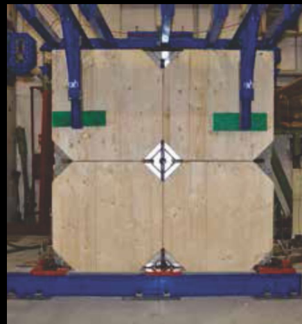
Ensaio experimental de parede dividida em 4 partes com ligações X-RAD
