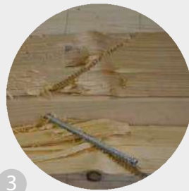
Muestra madera/madera probada con tornillos VGZ a tracción-compresión
