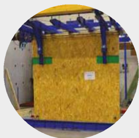
Paredes de entramado ligero durante la prueba
