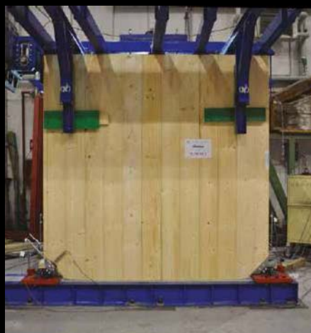
Prueba experimental pared con X-RAD y fijación al suelo
