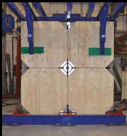
Prueba experimental pared dividida en 4 partes con conexiones X-RAD
