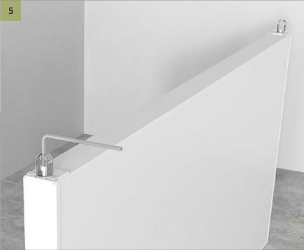
Conecte un clip de fijación a ambos extremos de los baffles con una llave hexagonal y un perno M6. Asegúrese de que los clips estén ubicados paralelos a la longitud del baffle
