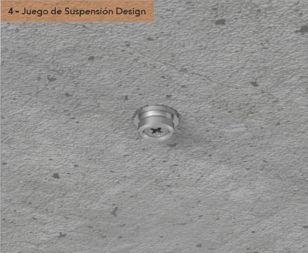
Fije la parte superior del Juego de Suspensiones Rockfon Baffle Design (el que tiene rosca M13 externa) al techo. Use los tornillos de fijación adecuados para el material del techo y lo suficientemente pequeños para la cubierta cilíndrica de los Juegos de Suspensión Rockfon Baffle Design (diámetro máximo de la cabeza 12 mm) - use el símbolo del diámetro
