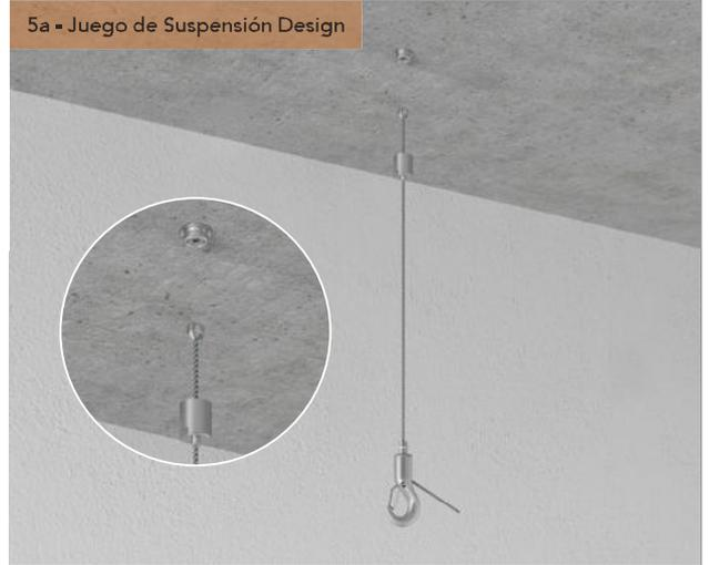
Deslice el cable de alambre del Juego de Suspensión de Diseño a través de la cubierta cilíndrica, de modo que el ojal del extremo del cable quede oculto en su interior. Atornillelo en la rosca M13. Puede acoplar el gancho ajustable al extremo inferior del alambre
