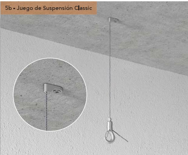
Fije el extremo del cable con ojal de 6,5 mm al techo a través de tornillo de fijación. Puede conectar el gancho ajustable al extremo inferior del alambre
