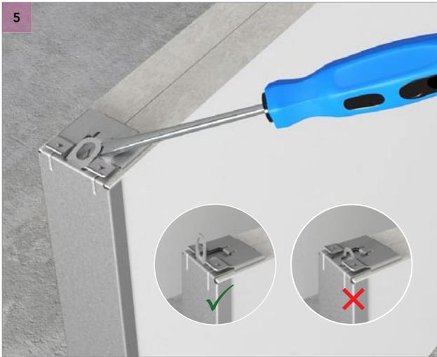
Levante el ojal plano en la parte superior del Rockfon Industrial Baffle.
