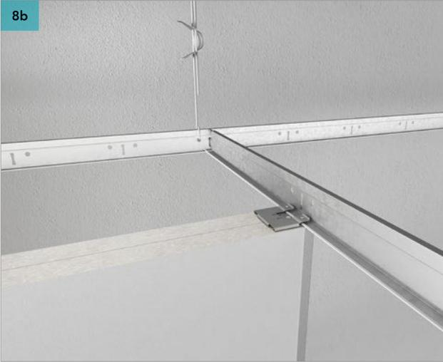
Fije el Rockfon Industrial Baffle a la perfilera suspendida T24. Puede usar las ranuras de los perfiles T24 para alinear los baffles.
