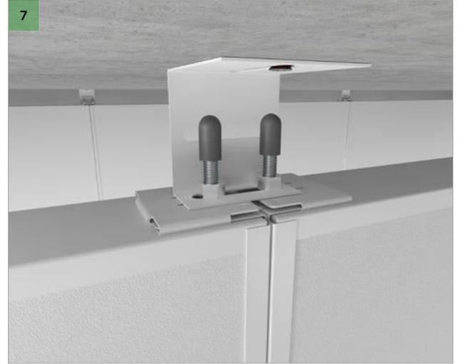
Coloque el siguiente baffle en el Soporte de Fijación Directa ECR y ajuste la posición, de modo que ambos baffles estén nivelados e incluso en línea. Use la perforación en el extremo de los baffles para alinear su posición.
