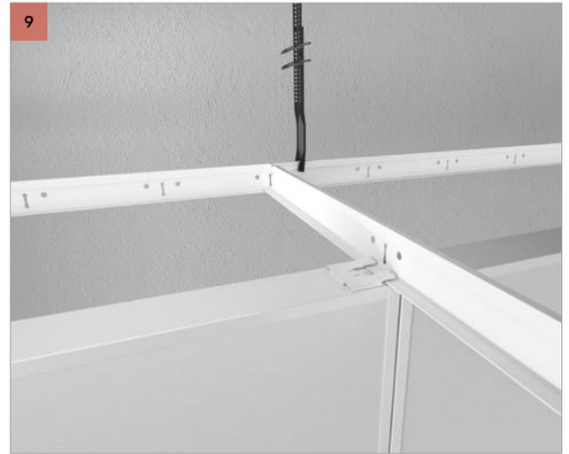
Dos baffles suspendidos en una ranura de perfiles T24 ECR. Use las perforaciones a los lados de los deflectores para alinearlos perfectamente.
