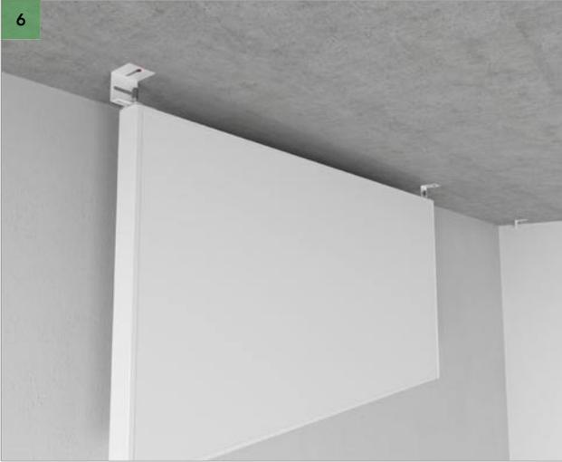
Sujete su baffle al Soporte de Fijación Directa ECR bloqueando la tuerca M6 en el extremo superior de la rosca M6, cuando esté por encima del soporte. No apriete las tuercas hasta el último momento, cuando nivele todos los Rockfon Humitec Baffles. En entornos adversos, recuerde utilizar componentes de clase D. Si es necesario, ajuste la posición de un baffle Rockfon Humitec con tuercas M6 y agujeros ovales en los Soportes de Fijación Directa ECR.
