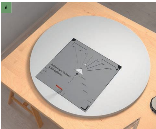
Coloque la plantilla para que las líneas centrales dibujadas en el paso 5 estén perfectamente alineadas con el punto en la base del triángulo de la plantilla y marque la posición del espaciador. Vea 6 - Detalle
