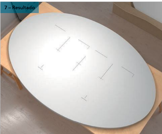
Mida e indique horizontalmente 300 mm a la izquierda y 300 mm a la derecha desde la cruz central
