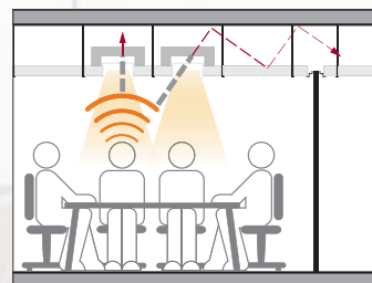
Con luminarias y silenciadores.
