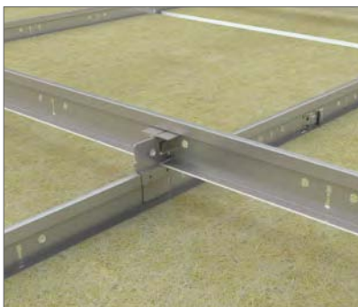
Conexión entre los perfiles del nivel superior y del nivel inferior con el clip DLC. Mejora la estabilidad del sistema y facilita su instalación.
