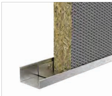
El perfil en J de 40 mm (25/40/13 mm) y la escuadra de apoyo para soportar la parte inferior de los paneles montados a múltiples alturas o fuera del piso.
