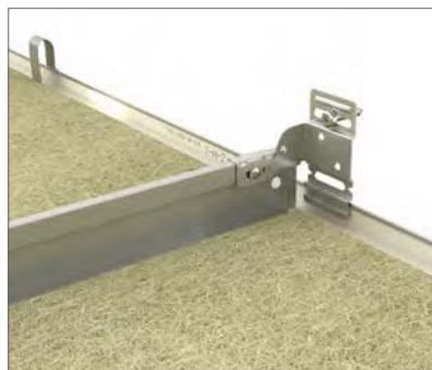
Para asegurarse de que el sistema T24 X permanezca recto, se recomienda usar un soporte de pared y puente en cada perfil primario y perfil secundario.
