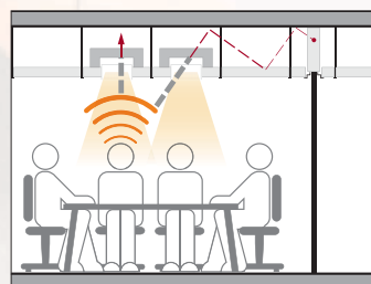
Con luminarias, silenciadores y barrera acústica 30 dB.
