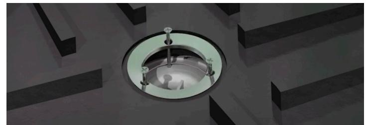
■ 2\_8\_Colocar el aro metálico, insertar los tornillos y atornillar hasta sellar totalmente el aro a la salida del plato.
