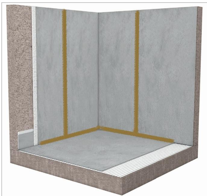
3. Extender una capa fina de cemento cola C2 S1/S2 con la llana de 4 mm y revestir la pared con la lámina **ECODRY50** dejando un solape entre láminas de al menos 5 cm. Comprobar que la lámina esté bien extendida y sacar el aire que se pueda haber generado con ayuda de la llana. Sellar las uniones con **SEALPLUS** realizando un doble sellado (ver punto 2.).
