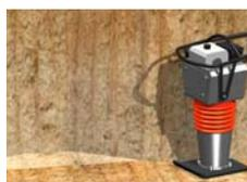
Se nivela y compacta adecuadamente la base de la excavación y si los estudios del terreno lo requieren se preparará el fondo de la excavación con material seleccionado y compactado.
