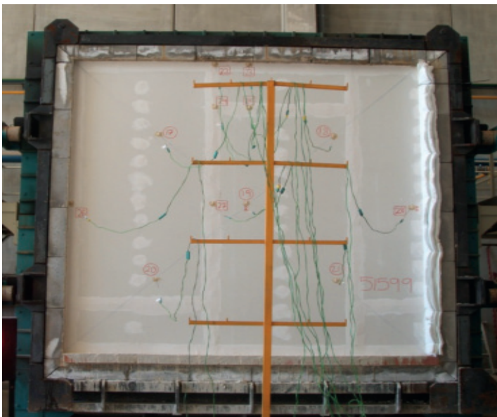
Ensayo de Resistencia al fuego en tabique. Horno de 3 x 3 m
