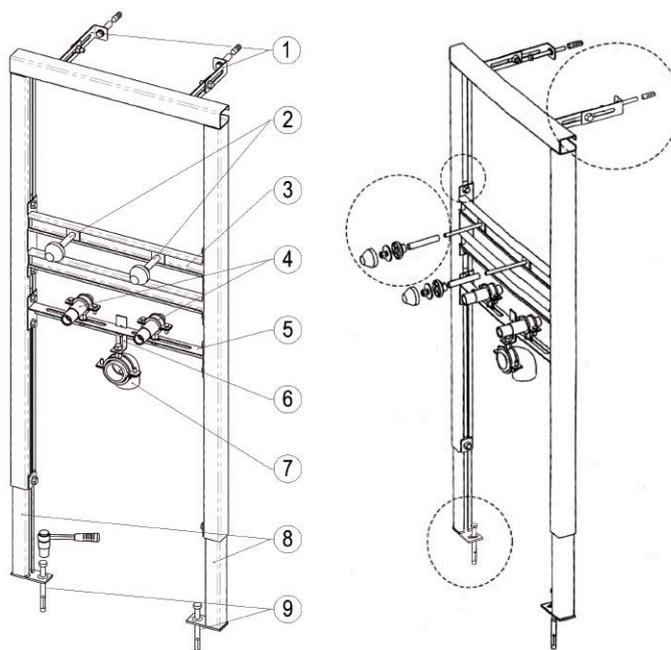
**PASO 1** Posicionar ①, y fijar con tacos. DETALLE D
