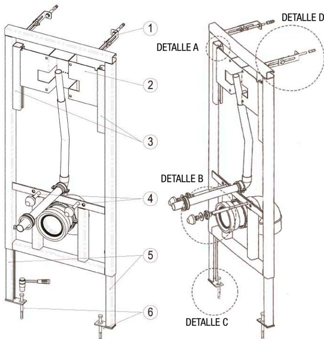
**PASO 1** Posicionar ①, y fijar con tacos. DETALLE D
