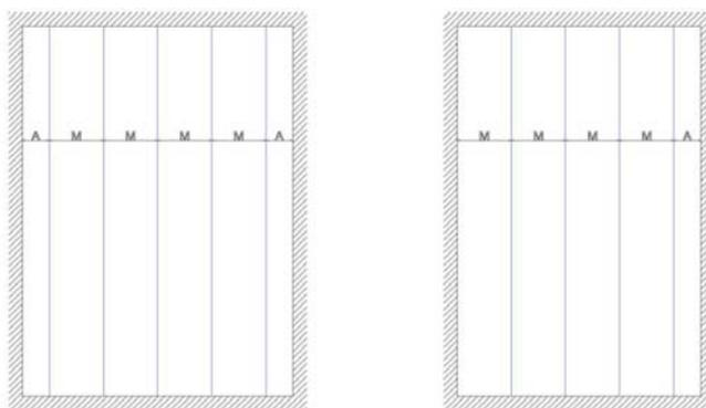
Ilustración 10. Ejemplo de replanteo de perfiles T-45.
