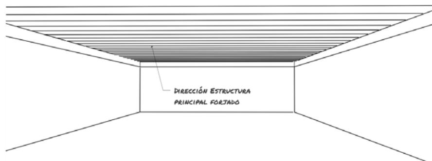
Ilustración 9. Dirección estructural principal del forjado.
