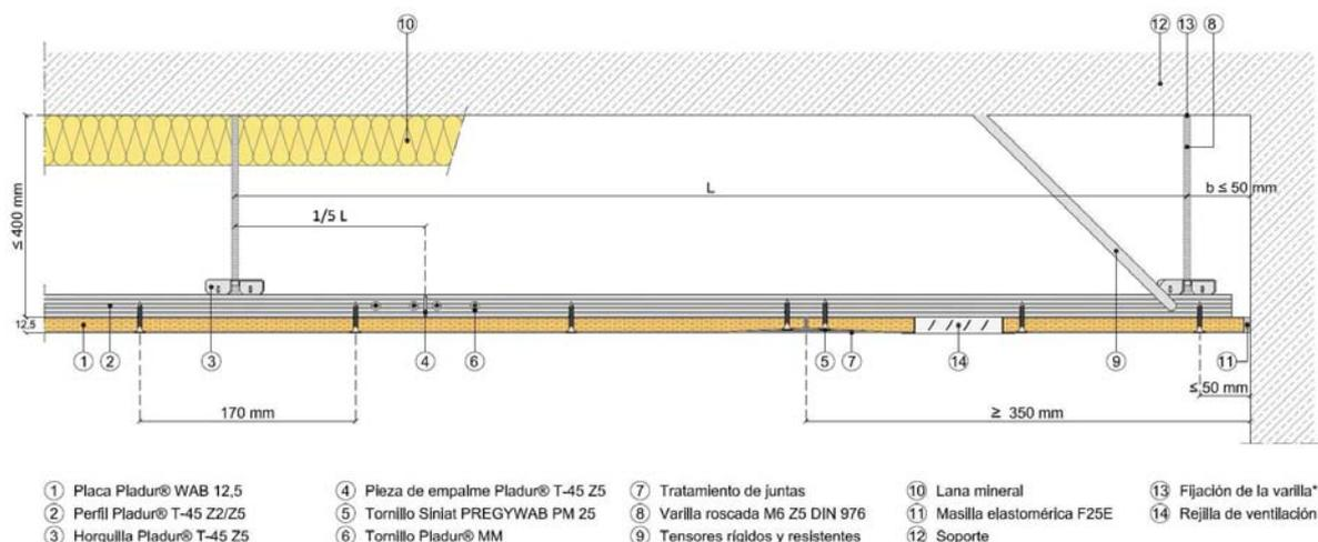
\* La fijación no forma parte del sistema Pladur® y debe cumplir la especificación definida para dichos componentes en base a las tablas de cargas definidas en el Technical Conformity. Los tensores no están incluidos en el Technical Conformity.
