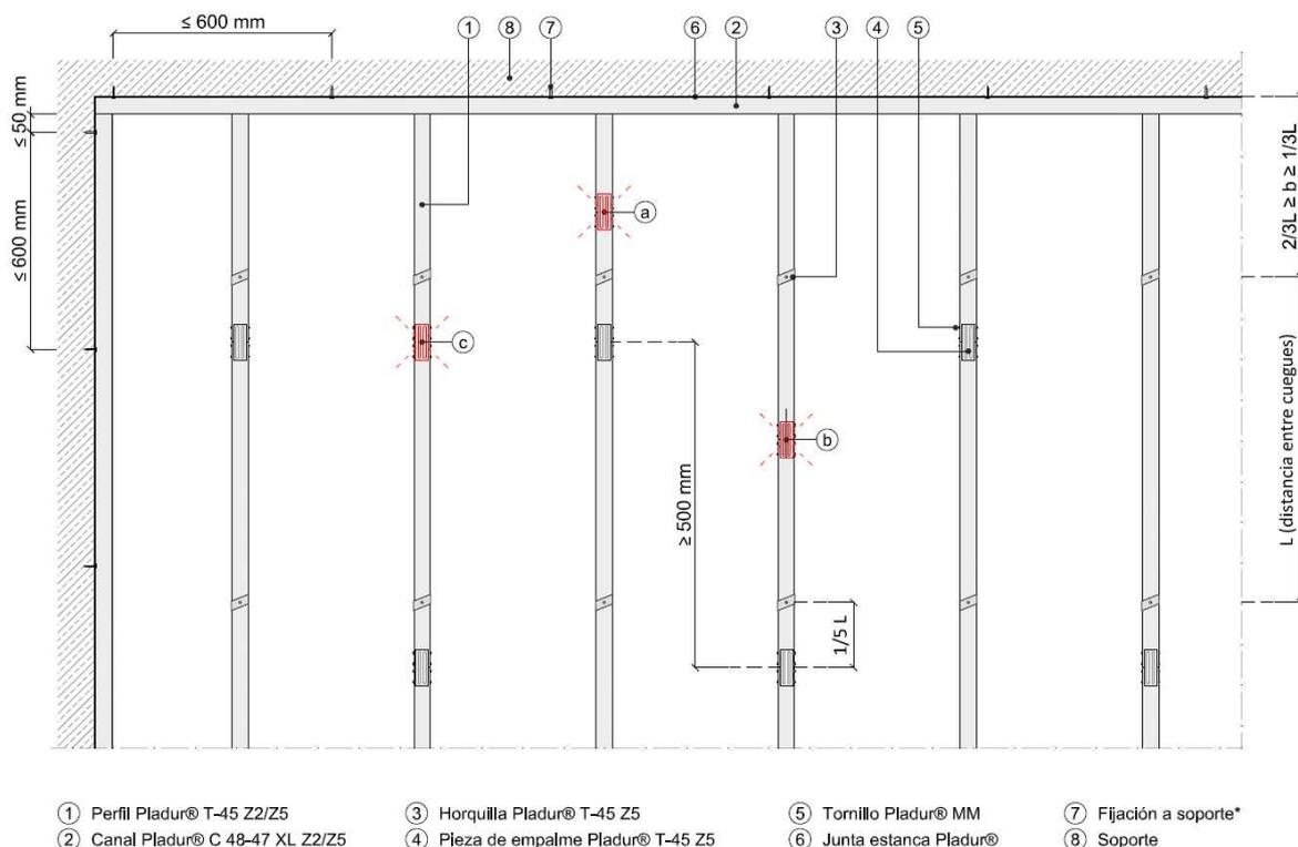
Ilustración 6. Disposición de empalmes en techos Pladur® WAB de semi-intemperie.
