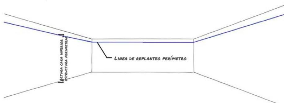
Ilustración 8. Replanteo perímetro.
