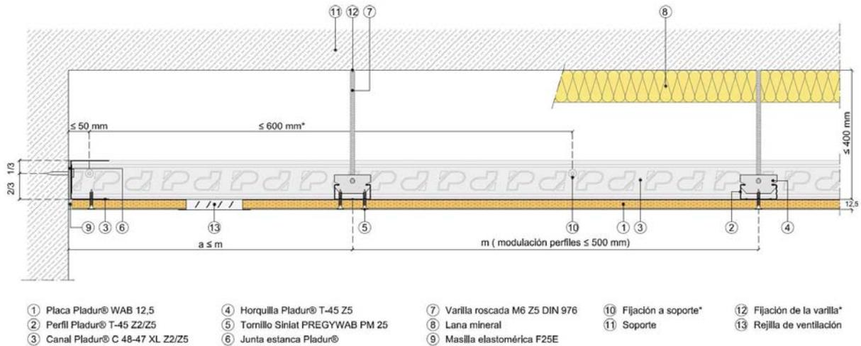
\* La fijación no forma parte del sistema Pladur® y debe cumplir la especificación definida para dichos componentes en base a las tablas de cargas definidas en el Technical Conformity.
