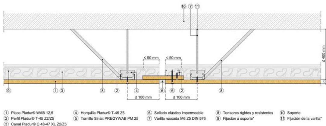
\* La fijación no forma parte del sistema Pladur® y debe cumplir la especificación definida para dichos componentes en base a las tablas de cargas definidas en el Technical Conformity. Los tensores no están incluidos en el Technical Conformity.
