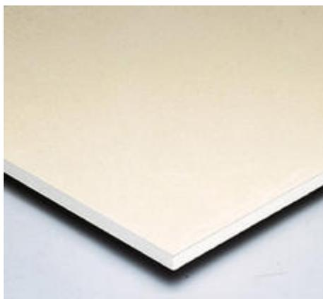
Plaque de plâtre hydrofugée H1 renforcée fibres de bois et à 2 bords amincis, très haute dureté, haute résistance aux chocs, acoustique et intégrant l'innovation Activ'Air®.
