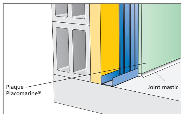
Sur sol brut en pied de doublage, les plaques Placomarine® sont protégées par un film polyéthylène d'épaisseur 100 µ.
