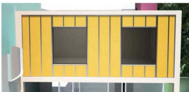
Figura 6.2: Panel aislante en las cavidades de la subestructura.
