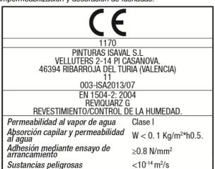
Cumple normativa UNE-EN para Productos y sistemas para la protección y reparación de estructuras de hormigón.
